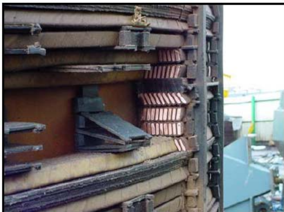
Figura 16 y 17 - Conductores inclinados en la fase A (1)
