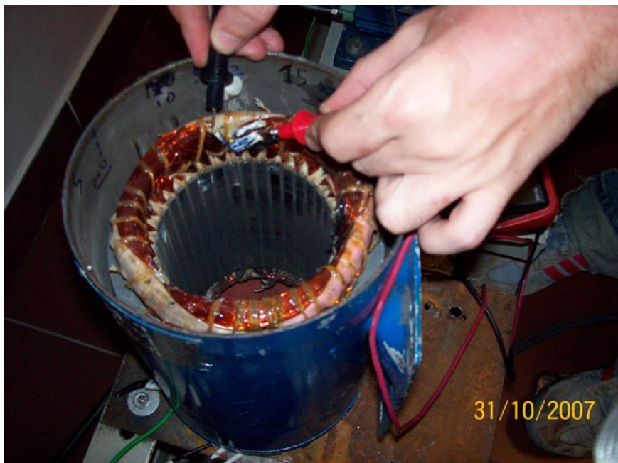
Figura 3: Medición de voltaje en el estator.
