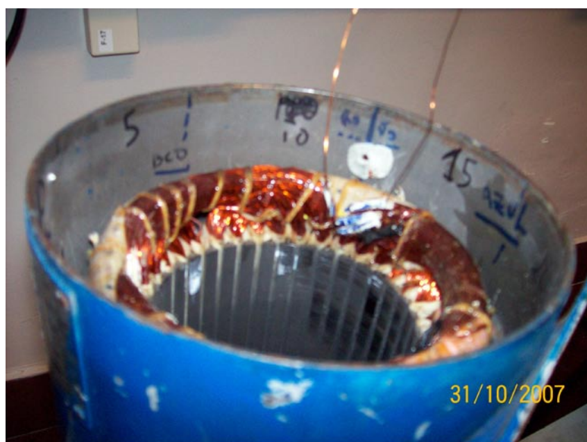
Figura 4: Conexión para realizar el cortocircuito
